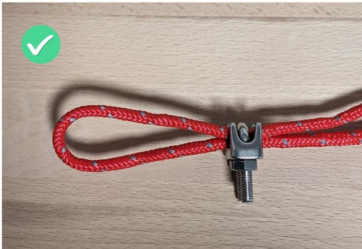
Abbildung 4 Drahtseilklemme an der richtigen Position wenn ohne Kauschen gearbeitet wird
