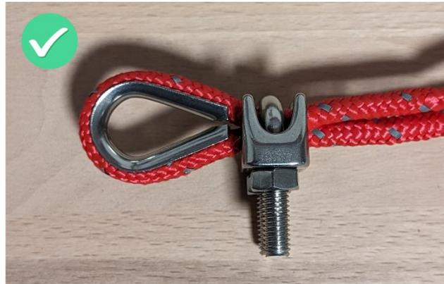
Abbildung 3b Kausche an der richtigen Position
